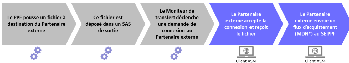
Figure 63 : Schéma d'un circuit retour d'un transfert par protocole AS/4
