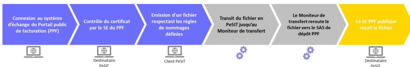
Figure 56 : Schéma d'un circuit aller d'un transfert par protocole PeSIT
